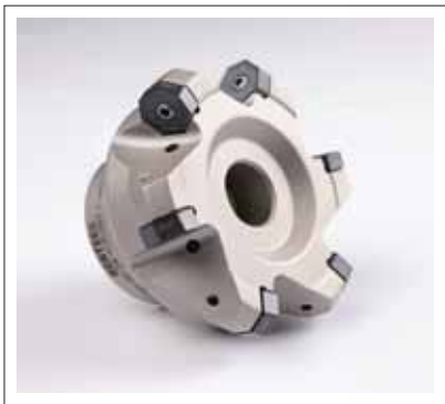
Фреза AFM45-XN07 с 14-кромочными режущими пластинами с PVD покрытием применяется для чернового фрезерования плоскостей фланца.
